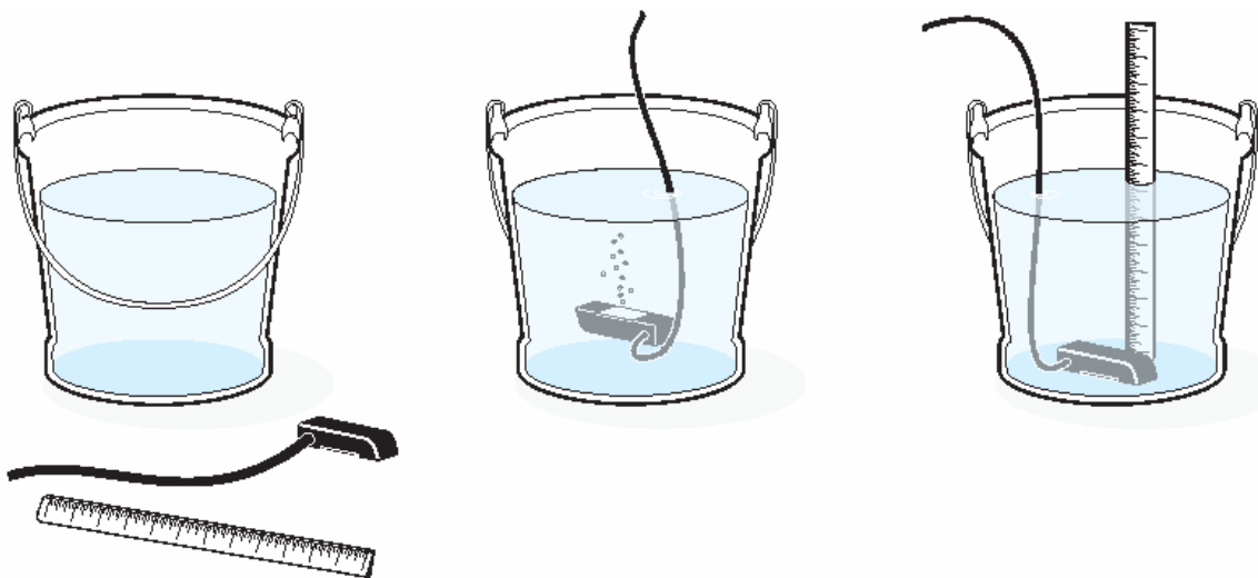
图 8 校准浸入式面积/速率传感器
